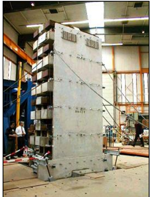
Figure 7: « un essai de structure à mur en béton sur la table sismique Azalée du CEA Saclay »
